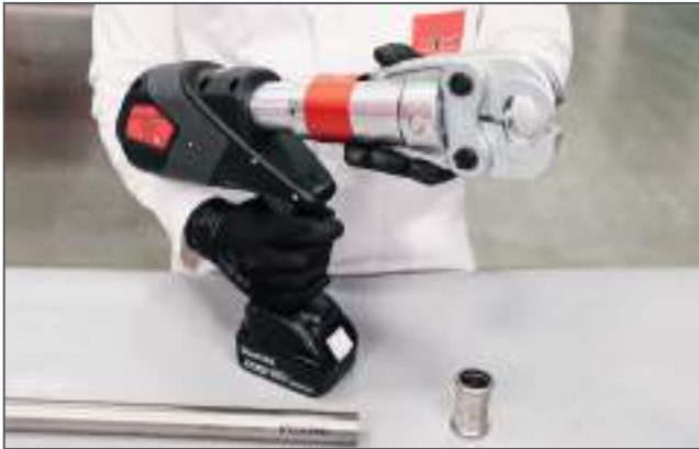
Preparazione della macchina pressatrice / Press machine preparation
